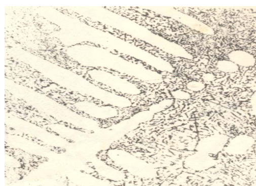
图 10 变质后铸态 Al-Si 合金
