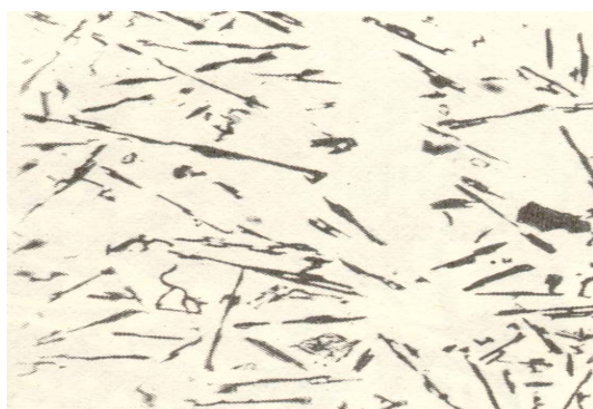
图 9 变质前铸态 Al-Si 合金
