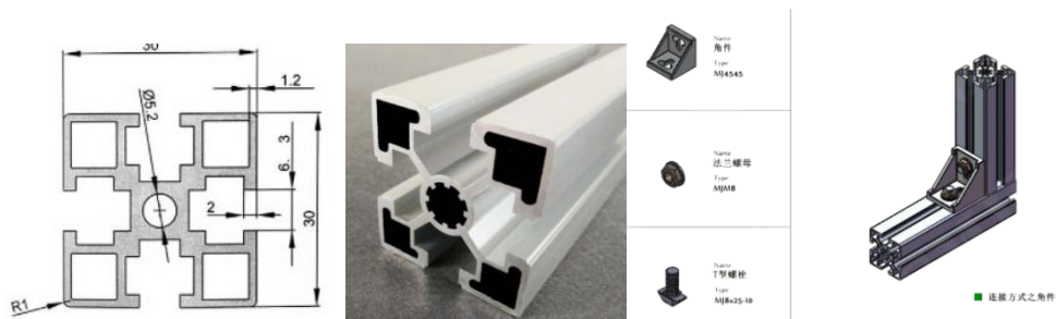
图 A3 45×45 铝合金型材及安装示意图
